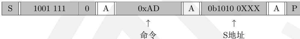
发送完 S 地址位信息后, 需要将设备重启, 以生效该地址, 可以发送命令:0xC0, 即可重启设备, 否则设备将延续旧的地址, 直至重启, 或者重新开机。
